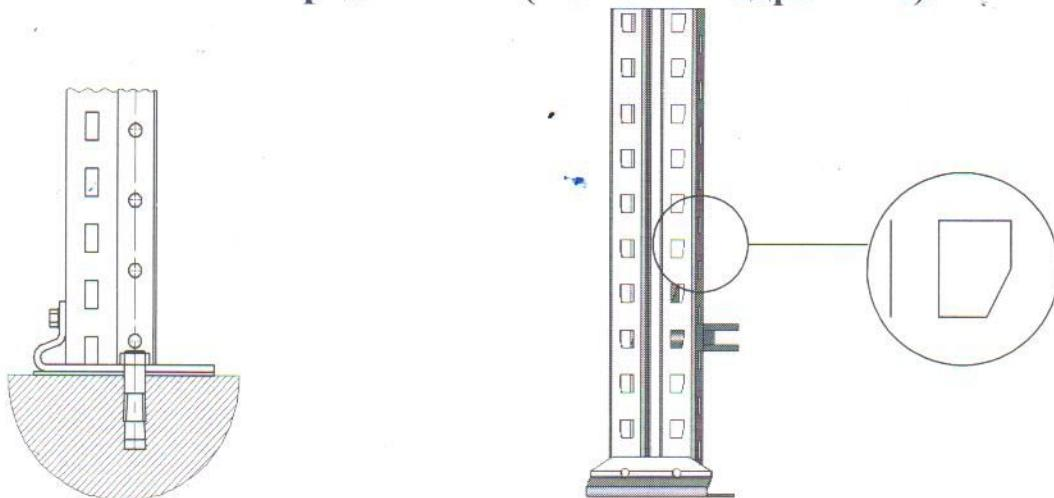
2.2. Две стойки в сборе с подпятниками соединить между собой связями горизонтальными и связями диагональными при помощи болтов M10x70, гаек M10 согласно комплектации и схемы сборки №1.
